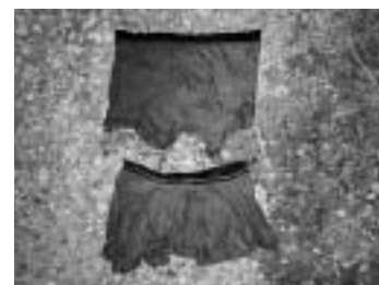
ポンプから除去した異物
